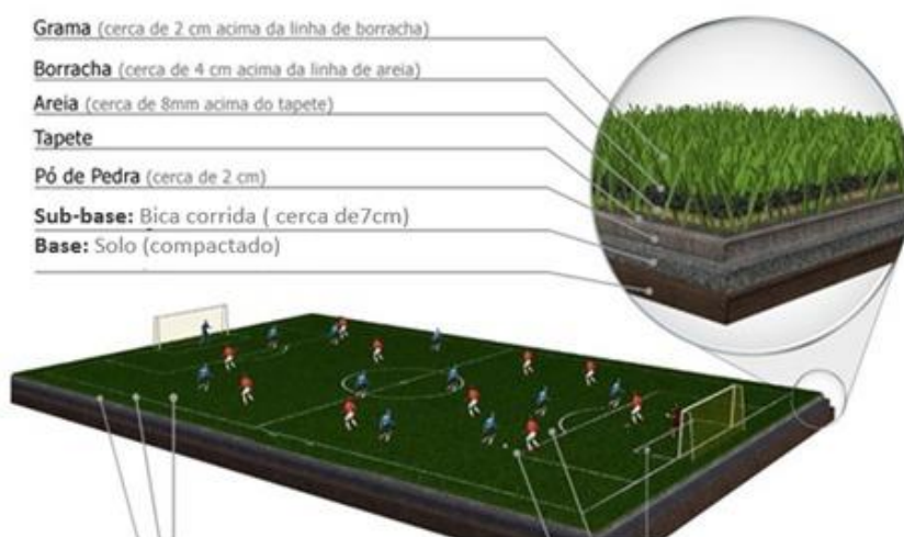
Figura 08– Detalhe Ilustrativo de Instalação e Revestimento (Grama Sintética) (Fonte: Adaptado brasgrama/2021)
