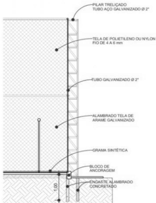
Figura 08 – Detalhe Ilustrativo de Instalação do Alambrado e Tela (Fonte: Aatoria/2021)
