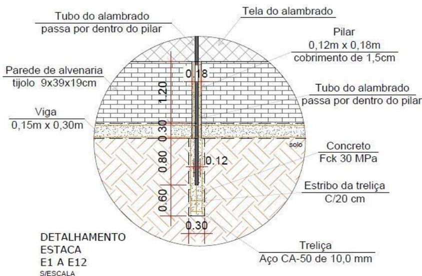
Figura 05 – Detalhamento de estaca (Fonte: Autora/2021)
