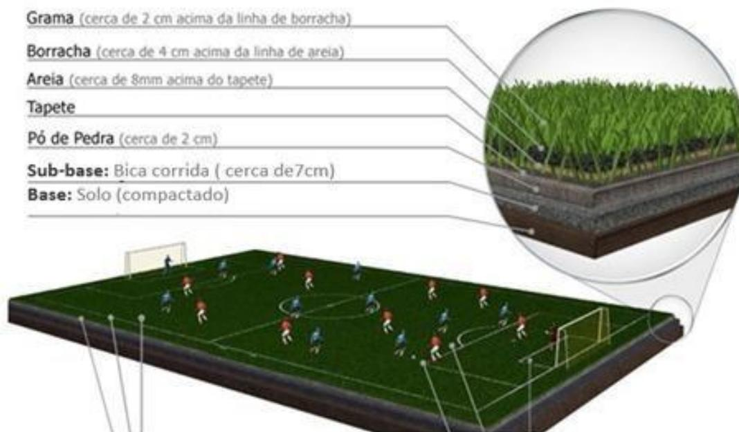
Figura 07– Detalhe Ilustrativo de Instalação e Revestimento (Grama Sintética) (Fonte: Adaptado brasgrama/2021)
