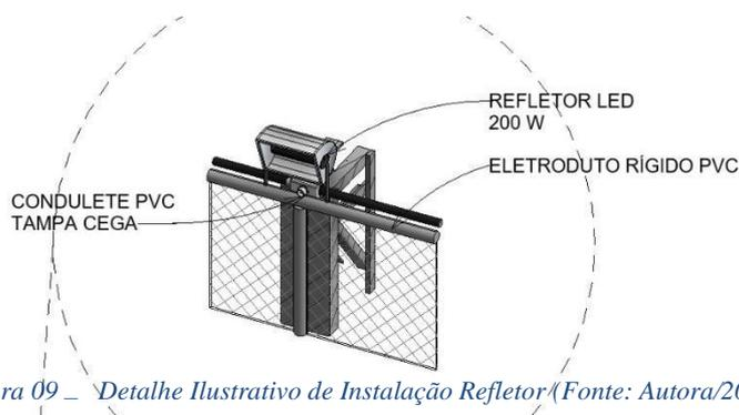
Figura 09 – Detalhe Ilustrativo de Instalação Refletor (Fonte: Autora/2021)
