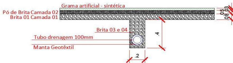
CORTE DETALHE VALA DRENAGEM SEM ESCALA
